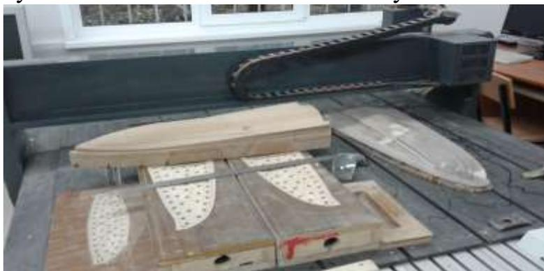
Оборудование является многофункциональным, так как выполняет резку, гравировку, тонирование, выполнение перфорации. Обработка осуществляется за счет воздействия лазерного луча на свободную или
